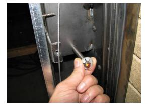
Deux connecteurs ovales filetés se trouvent de part et d'autre du bas du cadre de la porte à guillotine, à l'extérieur de chaque côté. Dévissez les deux connecteurs et laissez-les dévissés. Ne les décrochez pas du cadre de la porte à guillotine.
